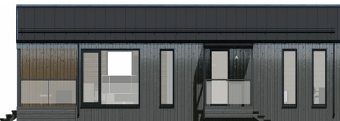
Typ-4: das Dach ist eine Klickfalte, die Fassade ist ein Baum vertikal
