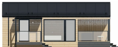
Typ-3: Das Dach ist eine Klickfalte, die Fassade ist ein Baum horizontal
