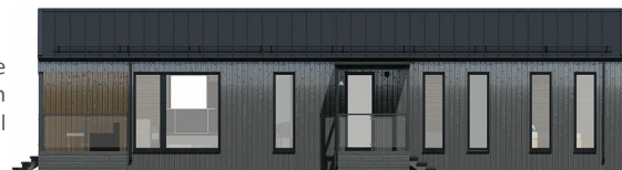
Typ-4: das Dach ist eine Klickfalte, die Fassade ist ein Baum vertikal
