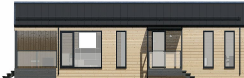
Typ-3: Das Dach ist eine Klickfalte, die Fassade ist ein Baum horizontal
