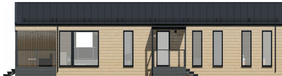
Typ-3: Das Dach ist eine Klickfalte, die Fassade ist ein Baum horizontal
