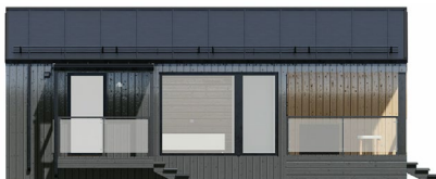
Typ-4: das Dach ist eine Klickfalte, die Fassade ist ein Baum vertikal
