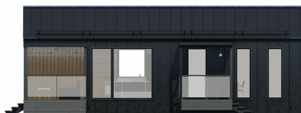
Тип-2: кровля клинфальц, фасад клинфальц
