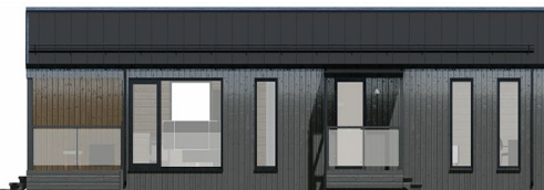
Тип-4: кровля клипфальц, фасад дерево вертикально
