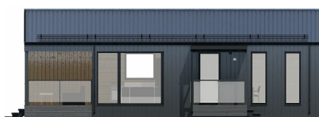
Тип-1: кровля металлический профиль, фасад металлический профиль
