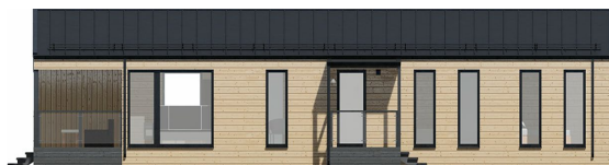
Тип-3: кровля кликфальц, фасад дерево горизонтально
