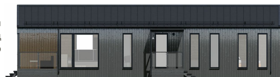
Тип-4: кровля кликфальц, фасад дерево вертикально
