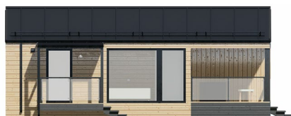
Тип-3: кровля клипфальц, фасад дерево горизонтально
