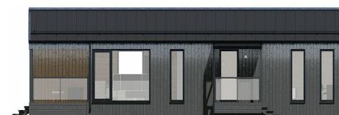
Тип-10: кровля кликфальц, фасад кликфальц 1/2 + дерево вертикально 1/2
