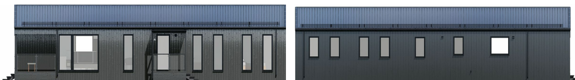
Тип-7: кровля металлопрофиль, фасад металлопрофиль 1/2 + дерево вертикально 1/2
