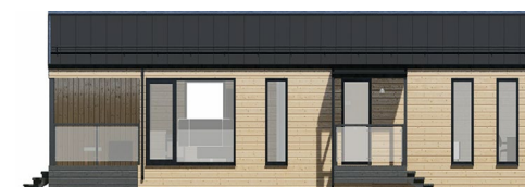
Тип-9: кровля кликфальц, фасад кликфальц 1/2 + дерево горизонтально 1/2
