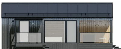
Тип-4: кровля клипфальц, фасад дерево вертикально
