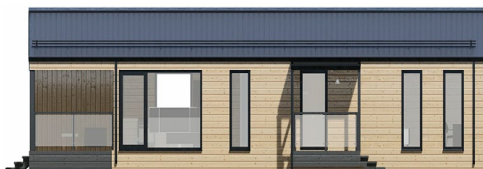
Тип-6: кровля металлопрофиль, фасад металлопрофиль 1/2 + дерево горизонтально 1/2
