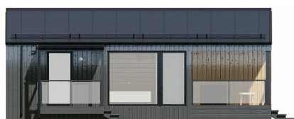
Тип-10: кровля клинфальц, фасад клинфальц 1/2 + дерево вертикально 1/2
