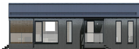
Тип-7: кровля металлопрофиль, фасад металлопрофиль 1/2 + дерево вертикально 1/2
