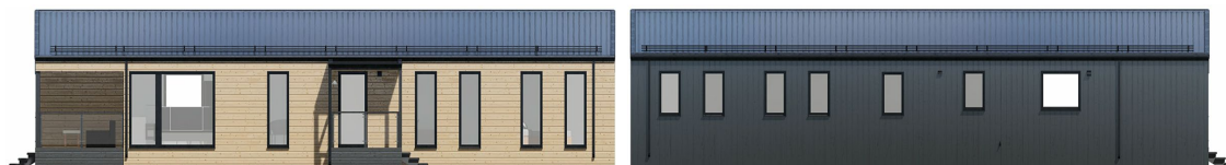
Тип-6: кровля металлопрофиль, фасад металлопрофиль 1/2 + дерево горизонтально 1/2
