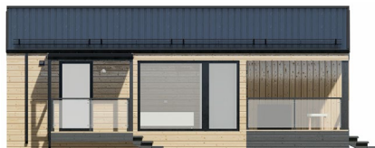
Тип-6: кровля металлопрофиль, фасад металлопрофиль 1/2 + дерево горизонтально 1/2
