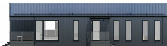
Тип-1: кровля металлический профиль, фасад металлический профиль
