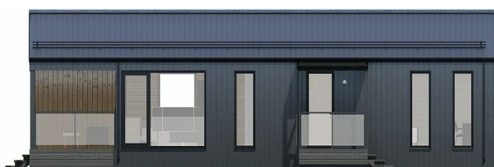
Тип-1: кровля металлический профиль, фасад металлический профиль
