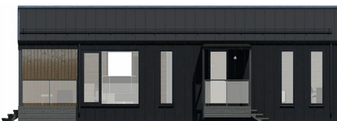
Тип-2: кровля клипфальц, фасад клипфальц
