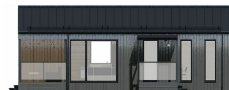
Тип-4: кровля клинфальц, фасад дерево вертикально
