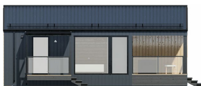
Тип-1: кровля металлический профиль, фасад металлический профиль
