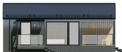
Тип-7: кровля металлопрофиль, фасад металлопрофиль 1/2 + дерево вертикально 1/2
