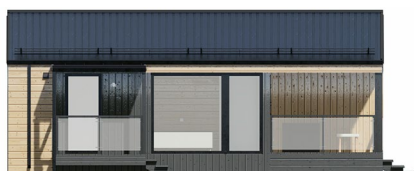
Тип-8: кровля металлопрофиль, фасад металлопрофиль 1/2 + дерево вертикально 1/2
