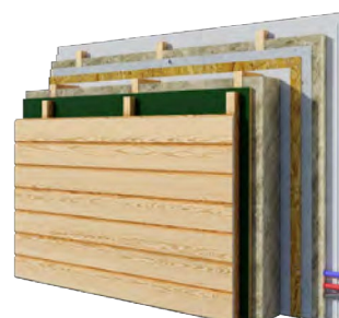
Разрез внешних стен с внутренней отделкой стен гипсокартоном.
