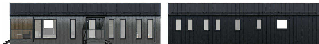
Тип-10: кровля клинфальц, фасад клинфальц 1/2 + дерево вертикально 1/2
