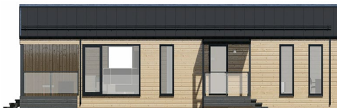
Тип-3: кровля клипфальц, фасад дерево горизонтально
