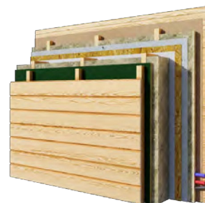
Разрез внешних стен с внутренней отделкой стен гипсокартоном.
