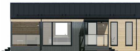
Тип-5: кровля клинфальц, фасад дерево микс
