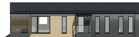
Тип-5: кровля кликфальц, фасад дерево микс
