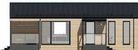
Тип-3: кровля клинфальц, фасад дерево горизонтально
