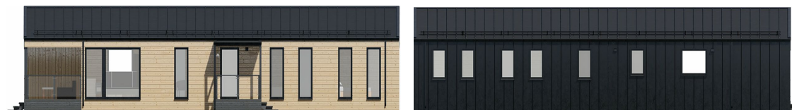
Тип-9: кровля клинфальц, фасад клинфальц 1/2 + дерево горизонтально 1/2
