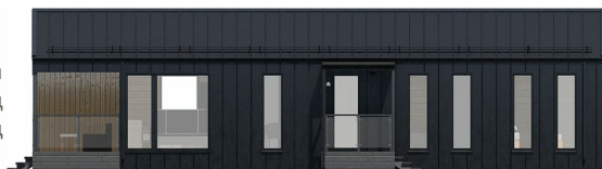
Тип-2: кровля кликфальц, фасад кликфальц
