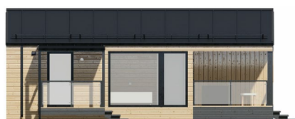
Тип-9: кровля клинфальц, фасад клинфальц 1/2 + дерево горизонтально 1/2
