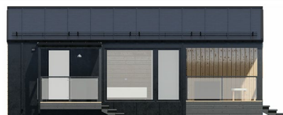
Тип-2: кровля клипфальц, фасад клипфальц
