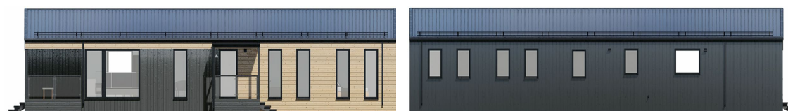
Тип-8: кровля металлопрофиль, фасад металлопрофиль 1/2 + дерево вертикально 1/2
