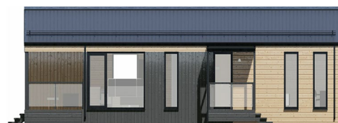
Тип-8: кровля металлопрофиль, фасад металлопрофиль 1/2 + дерево вертикально 1/2
